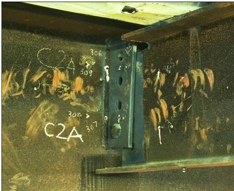
**Figura 2.8** Ligação com chapas finas depois do ensaio
