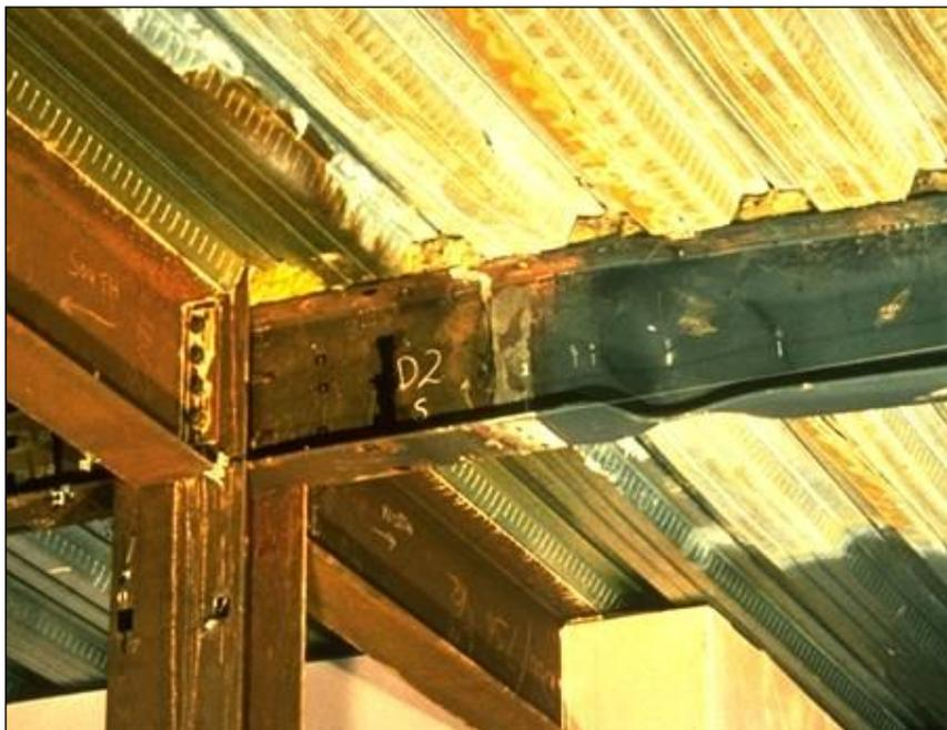
**Figura 2.5** Encurvadura do banzo na viga restringida
