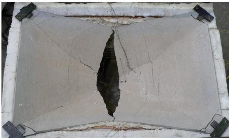
**Figura 4.6** Modo de rotura no ensaio das lajes a elevadas temperaturas
