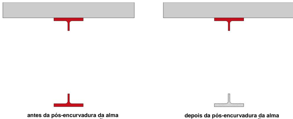
**Figura 6.3** Secção metálica antes e depois da Pós-Encurvadura da Alma
