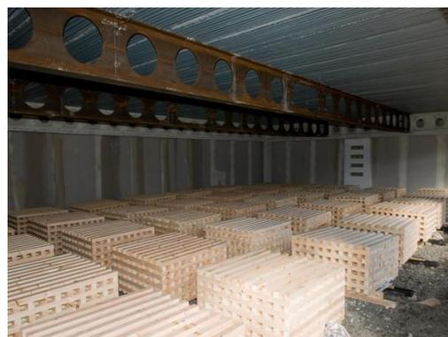
(b) Paletes de madeira utilizadas para aplicar a carga de incêndio
