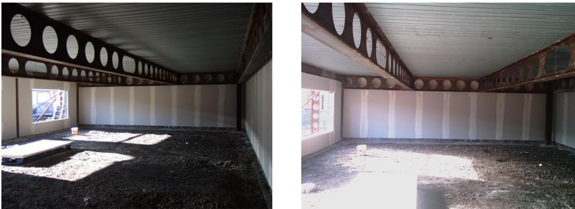
**Figura 7.44** Compartimento de ensaio com vigas alveoladas longas não protegidas
