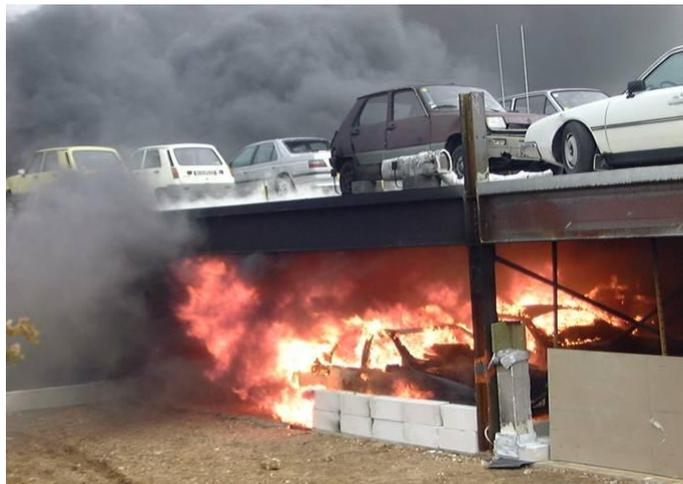
**Figura 3.3** Desenvolvimento completo do incêndio durante um ensaio ao fogo
