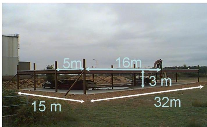
**Figura 3.1** Parque de estacionamento aberto antes dos ensaios ao fogo
