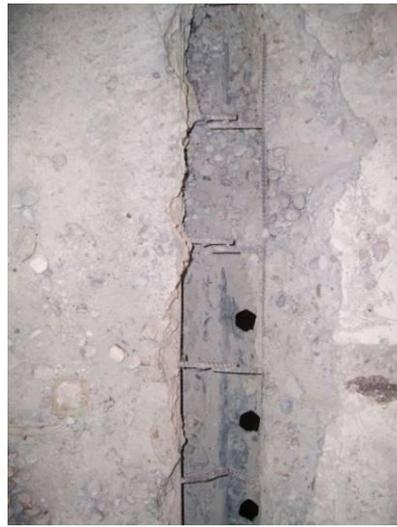
(b) Estado da ligação na armadura no local da fissuração após o arrefecimento
