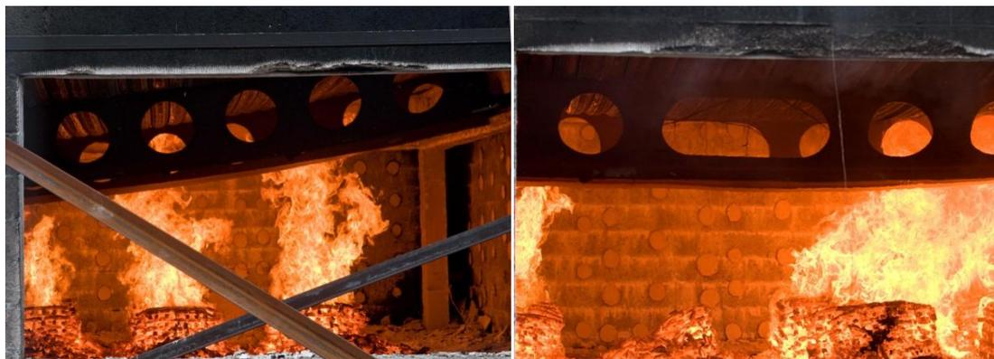
**Figura 7.52** Desenvolvimento do incêndio no compartimento
