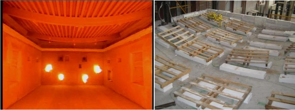
**Figura 7.38** Laje ensaiada durante e depois do incêndio
