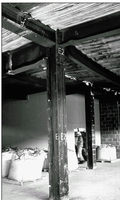
**Figura 2.10** Estado da estrutura depois do ensaio
