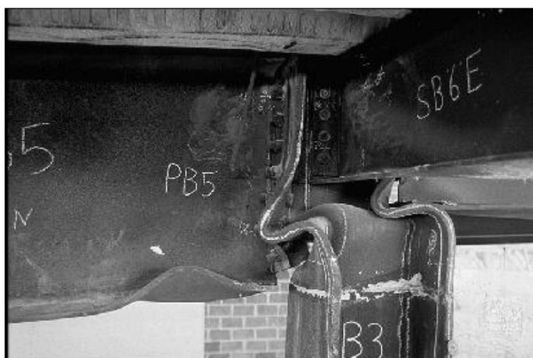
**Figura 2.7** Cabeça do pilar esmagada depois do ensaio
