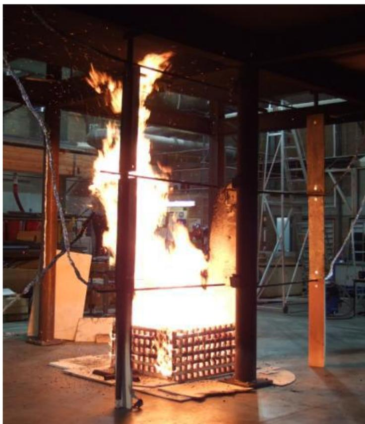
**Figura 3.7 Teste O36, apresentando a inclinação da chama**
