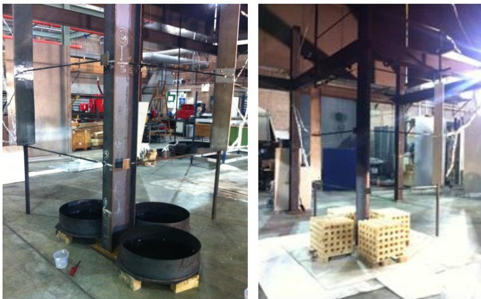
**Figura 3.4** Configuração dos testes para incêndios localizados realizados no FireSERT (esquerda: recipientes para conter o combustível líquido, direita: grades de madeira)
