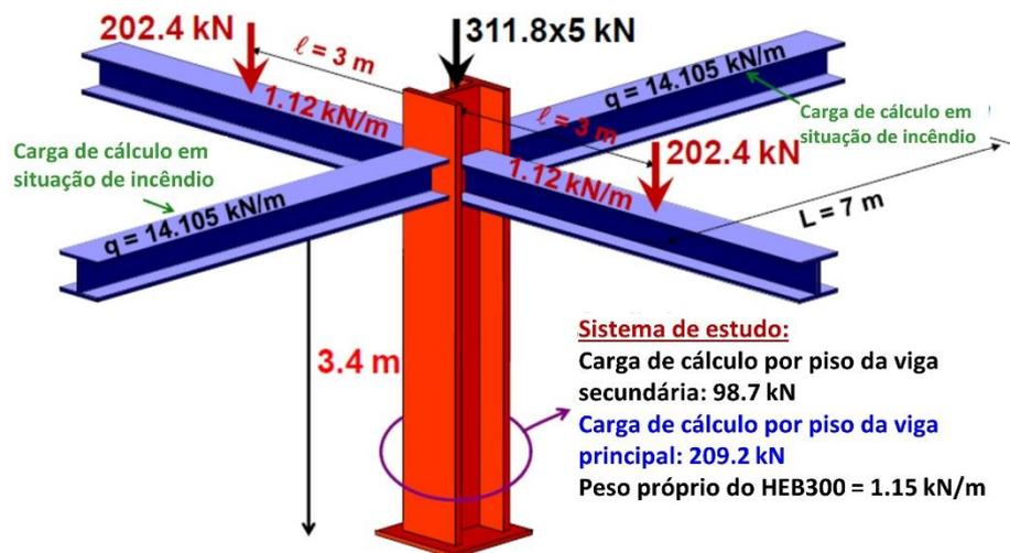
Figura D.13 Carregamento para a coluna do piso térreo
