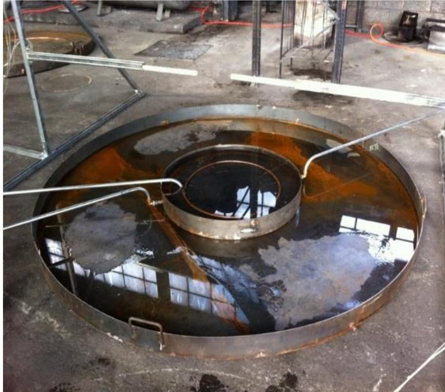
**Figura 3.3** Recipiente de 2 m de diâmetro, mostrando o mecanismo de alimentação de combustível (retirado de LOCAFI *Deliverable 15*<sup>[13]</sup>)
