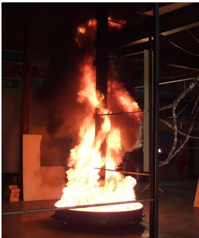
**Figura 3.1** Teste laboratorial de uma coluna sujeita a um fogo localizado
