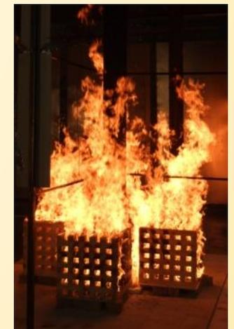
Estes testes confirmam que a correlação de Heskestad (NP EN 1991-1-2:2010) sobredimensiona as temperaturas tanto da chama ( $\theta_g \geq 500^\circ\text{C}$ ) como da pluma ( $\theta_g < 500^\circ\text{C}$ ).
